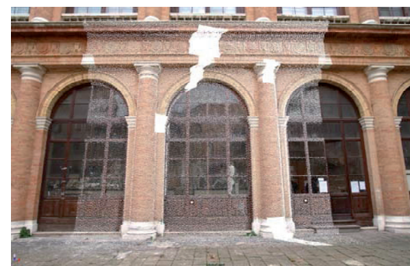
Fig.2. Superposition photographie/nuage de points
