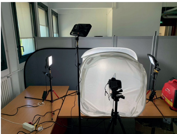
Fig 71. Installation pour l'acquisition de la maquette Panneaux LED et appareil photo sur trépied
