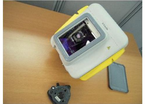
pour reconstruire des images de synthèses en 3D. Ce type de scanner à temps de vol longue distance consiste à déduire des distances à partir de mesures télémétriques. Le scanner émet une impulsion lumineuse et mesure son temps de retour. Ainsi, connaissant la vitesse de la lumière, ce dernier peut déduire la distance séparant l'objet et l'émetteur.
