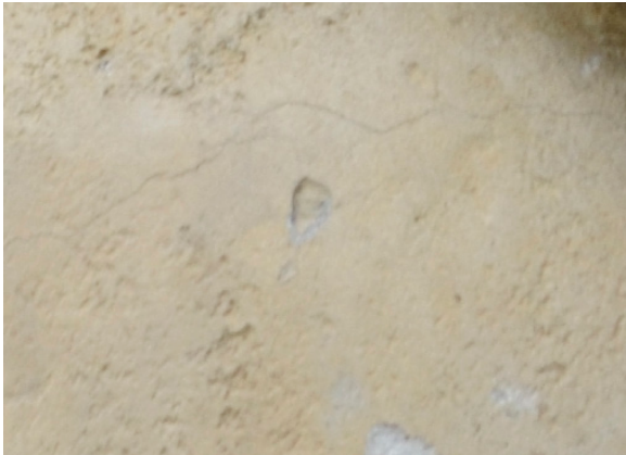
Photographies de la desquamation de la pierre sur la jambe droite de la statue
