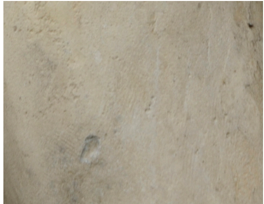
Photographies de la desquamation de la pierre sur la jambe droite de la statue
