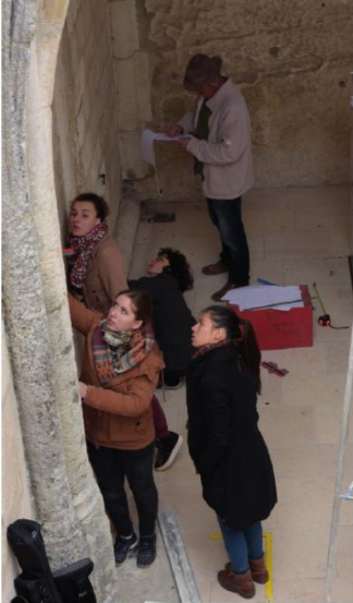
Comparaison des rayons d'arcs entre relevés manuels et photogrammétriques
