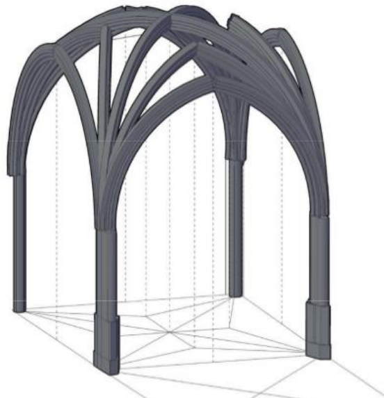
Comparaison des rayons d'arcs entre relevés manuels et photogrammétriques
